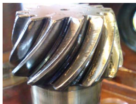
شکل ۶- اثرات خوردگی وسایش در چرخدنده پینیون شکل ۷- اثرات سایش در چرخدنده اصلی محور میکسر پس از صدور دستور کار تعمیراتی ، دستگاه به کارگاه ماشینری منتقل شد و کلیه قطعات از یکدیگر جدا شدند . و موارد ذیل مشاهده شد:
