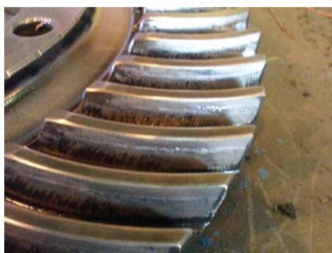
شکل ۶- اثرات خوردگی وسایش در چرخدنده پینیون شکل ۷- اثرات سایش در چرخدنده اصلی محور میکسر پس از صدور دستور کار تعمیراتی ، دستگاه به کارگاه ماشینری منتقل شد و کلیه قطعات از یکدیگر جدا شدند . و موارد ذیل مشاهده شد:
