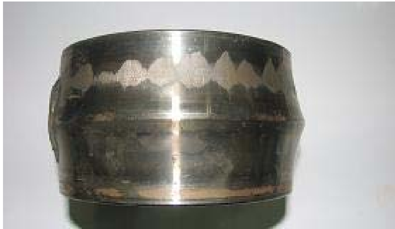
شکل ۱۲ - تصویر رینگ داخلی (Inner Race) آسیب دیده بیرینگ راکتور.
