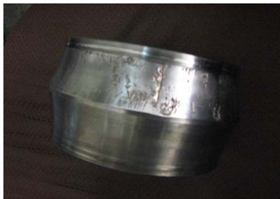
شکل ۷- کنس داخلی (Inner Race) معیوب یاتاقان بالایی محور میانی.
