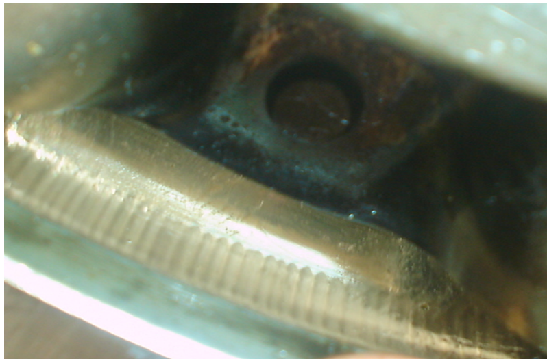
شکل (۵) شیار های مشاهده شده روی بیرینگ دستگاه مورد بحث
