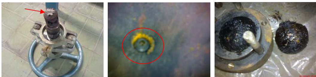
شکل ۵- تصویر سمت راست: نفوذ مازوت بداخل محفظه تریپ، تصویر وسط: خوردگی اطراف نازل خروجی محفظه تریپ، تصویر سمت چپ: خوردگی سطح آببندی Seat یک والو دستی
