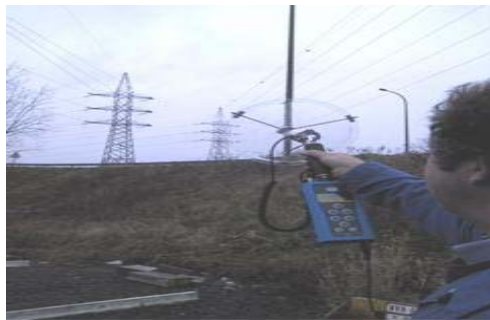
شکل ۶- ارزیابی خطوط انتقال توسط سنسور سهمی‌گون دستگاه آلتراسونیک
