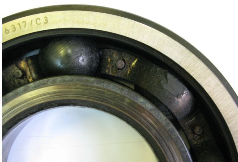
شکل هشت - خرابی کیج بیرینگ فن ۴۰۰۲
