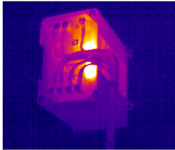
شکل ۱۳- تصویر مقاومت گرم در رله ها و رکوردرها
