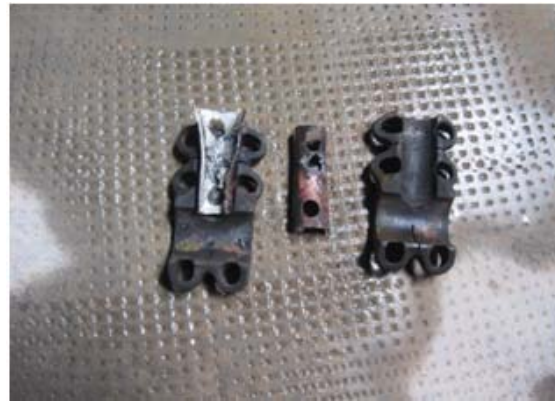
شکل ۳- کلمپ و بی متال آسیب دیده
